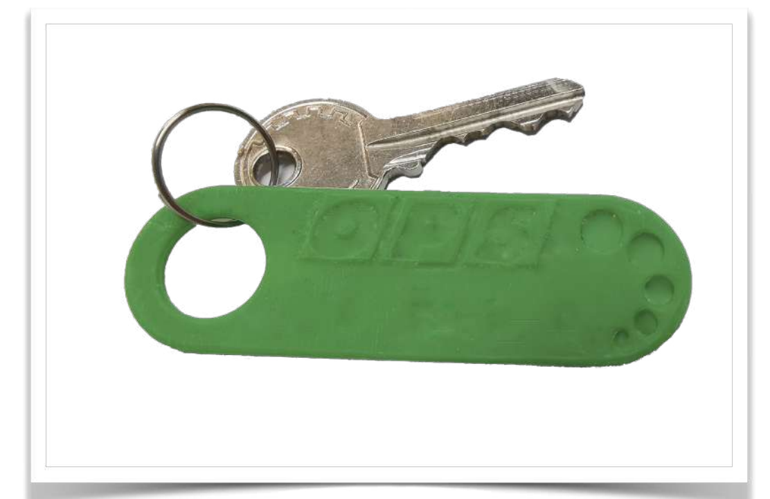
Pièce injectée avec une empreinte imprimée en 3D
