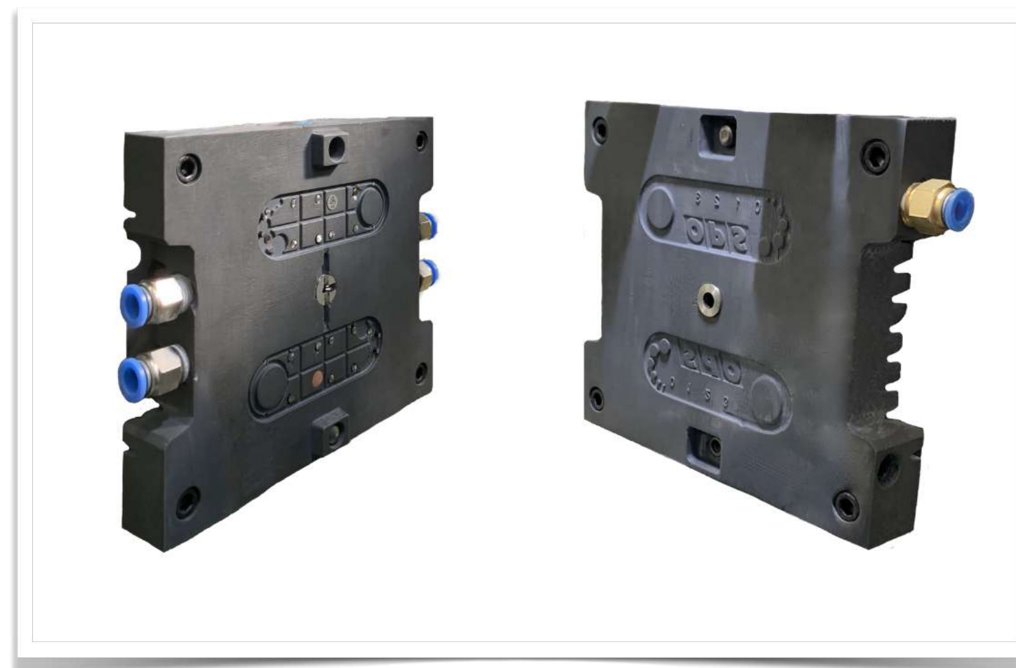
Pièce injectée avec une empreinte imprimée en 3D
